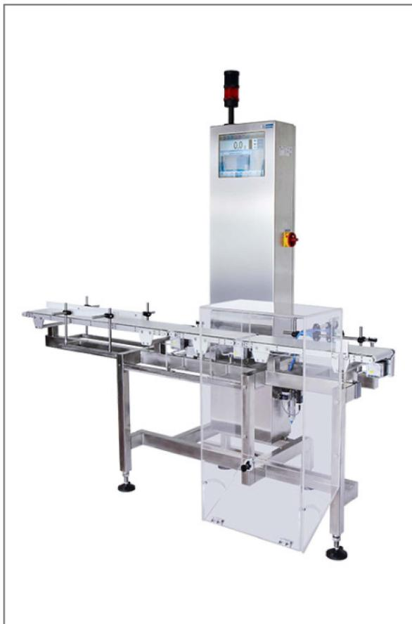
La balance de série DWT/HL/HP est une construction moderne, avancée et fiable qui garantit le processus de pesage de marchandises produites stable et sans pannes. La version optionnelle de la balance DWT/HL/HP équipée d'un détecteur de métaux détecte des éclats métalliques qui peuvent se trouver accidentellement dans les produits.
